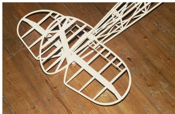
Les empennages du Stamp E, tout en lamellé collé balsa 10/10 (*sauf les nervures, également en balsa 10/10*)
