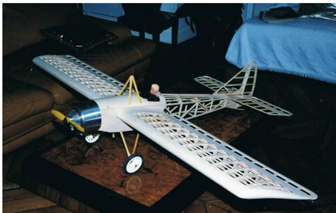
Avant, 1995 en thermique et 2006 en électrique, notez l'hélice retaillée et équilibré...
