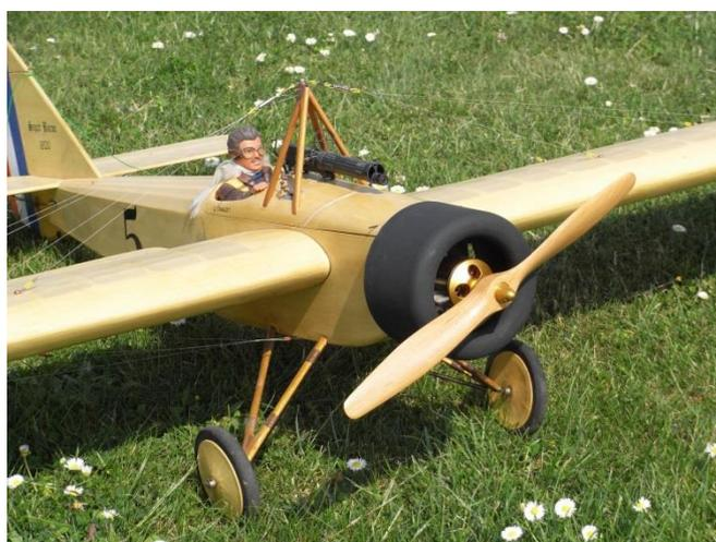
**Le monoplan parasol**, se travaille un peu comme le premier, mais avec une cabane et des haubans solides, une incidence légèrement négative, -1°, et plus si le plan est haut. Le dièdre peut être légèrement diminué. Les haubans inférieurs deviennent très utiles. J'ai appris à utiliser du câble VCC tressé, à la fois léger, fin et résistant (résistance connue), ce qui peut parfois être très utile !
